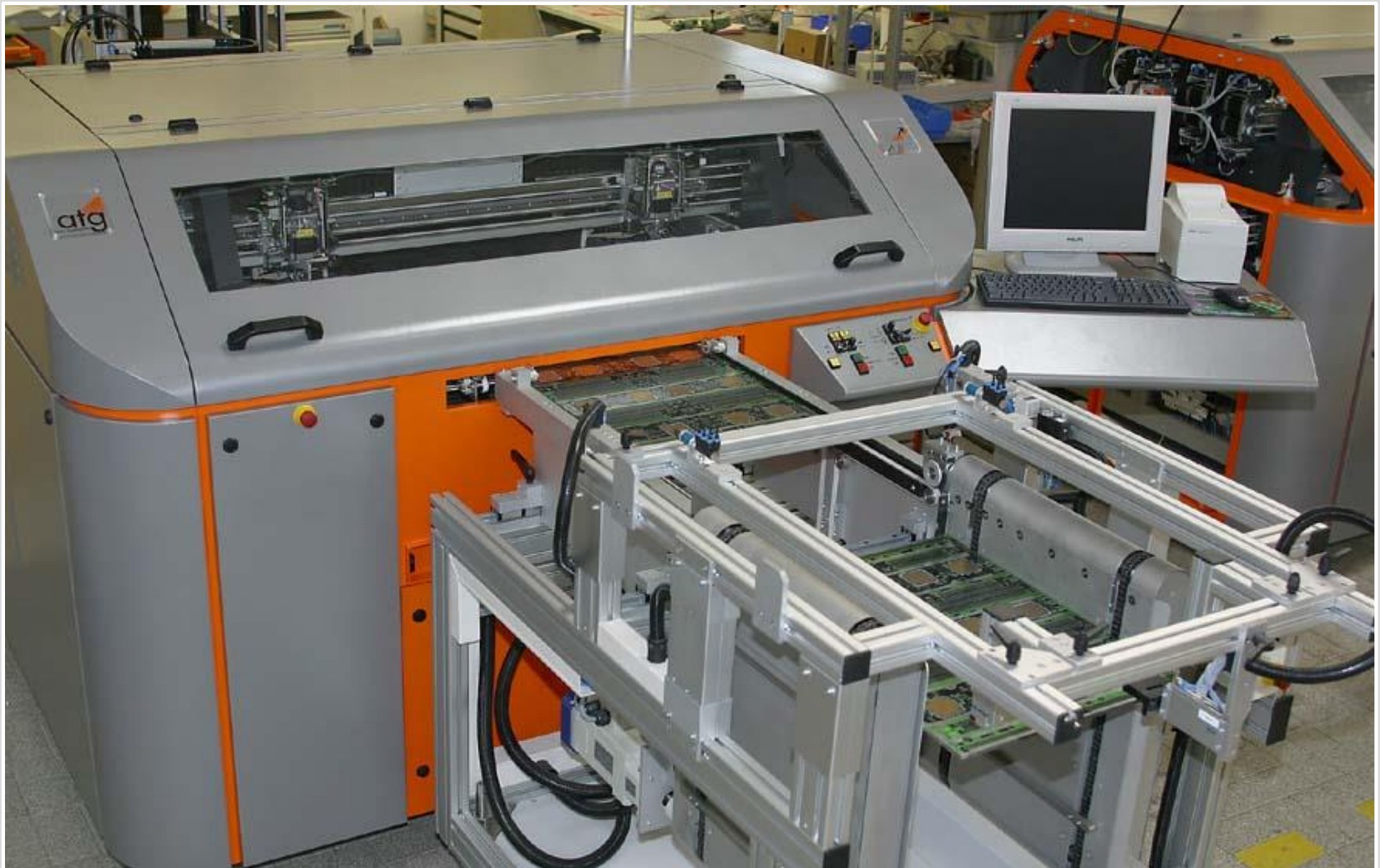
Tester für unbestückte Leiterplatten mit Zustapler
