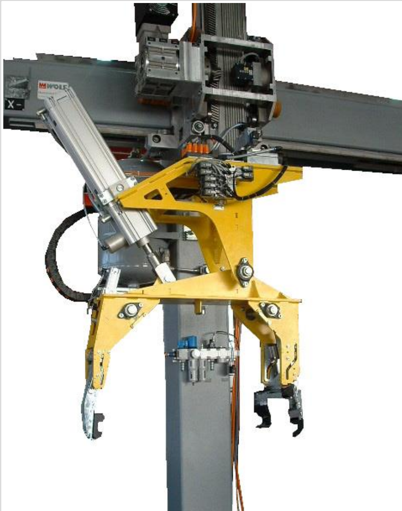
Montage Waschmaschinentrommel in Gehäuse
