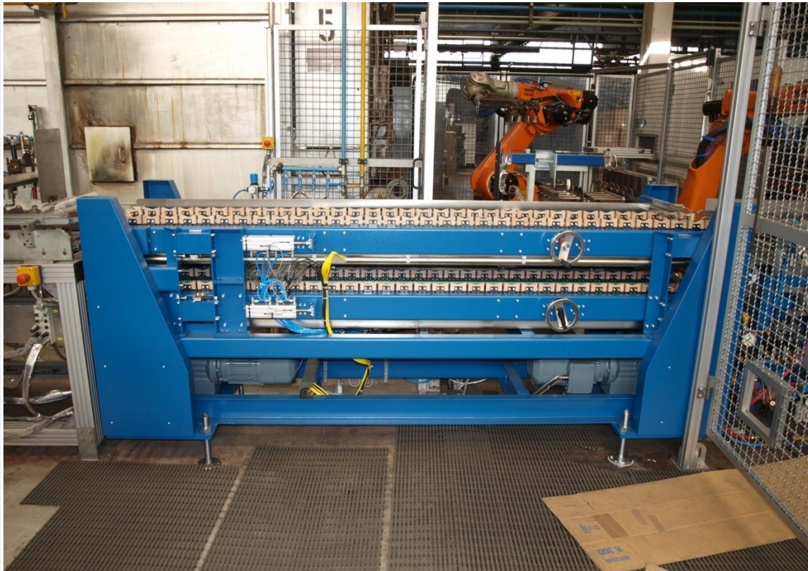
Transportstrecke für Messzylinder
