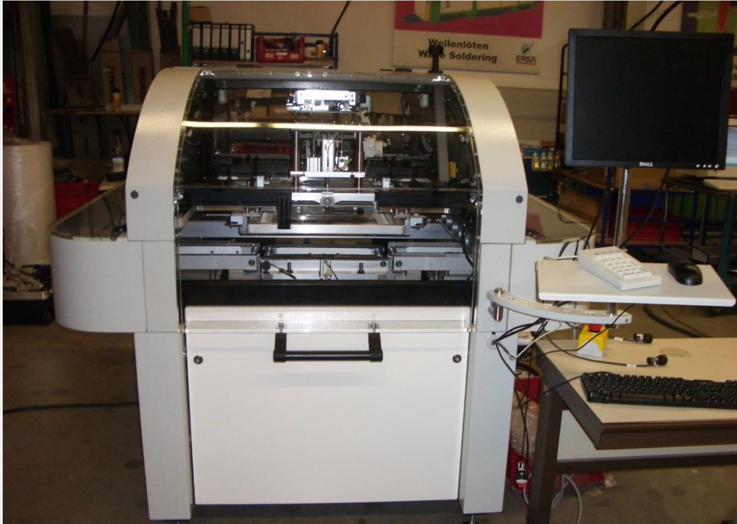
Schablonendrucker für Leiterplatten mit Zeilenkamera
