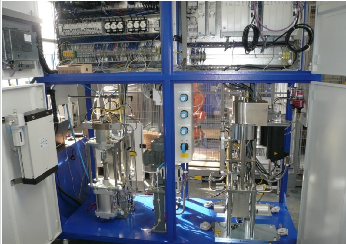
Versuchsaufbau zur Implementierung von Schaum im Kunststoffspritzprozess
