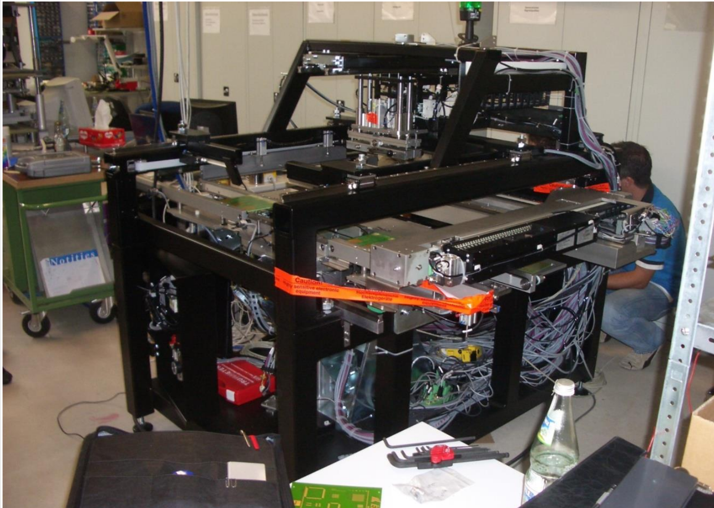
Schablonendrucker für Leiterplatten mit Zeilenkamera
