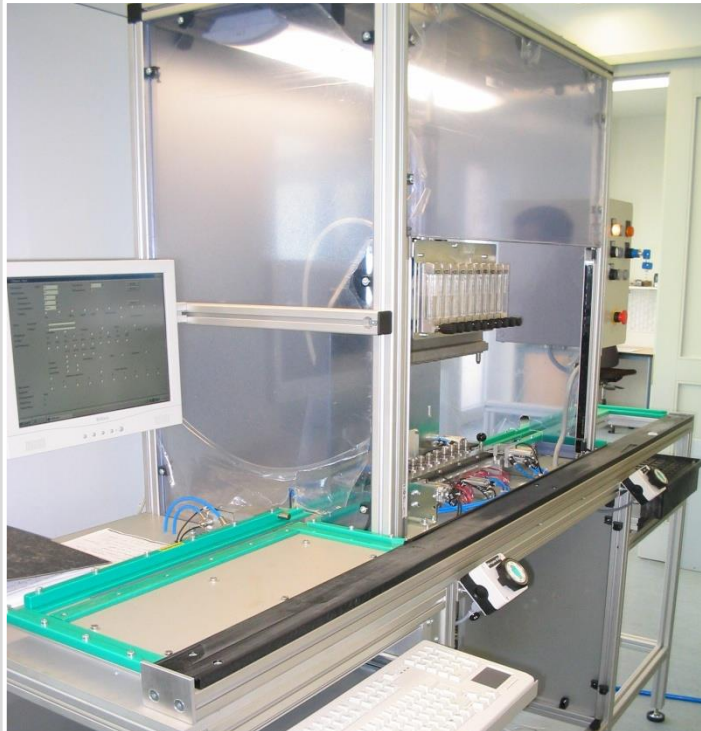
Prüfvorrichtung für den Gasdurchfluss in Lambdasonden
