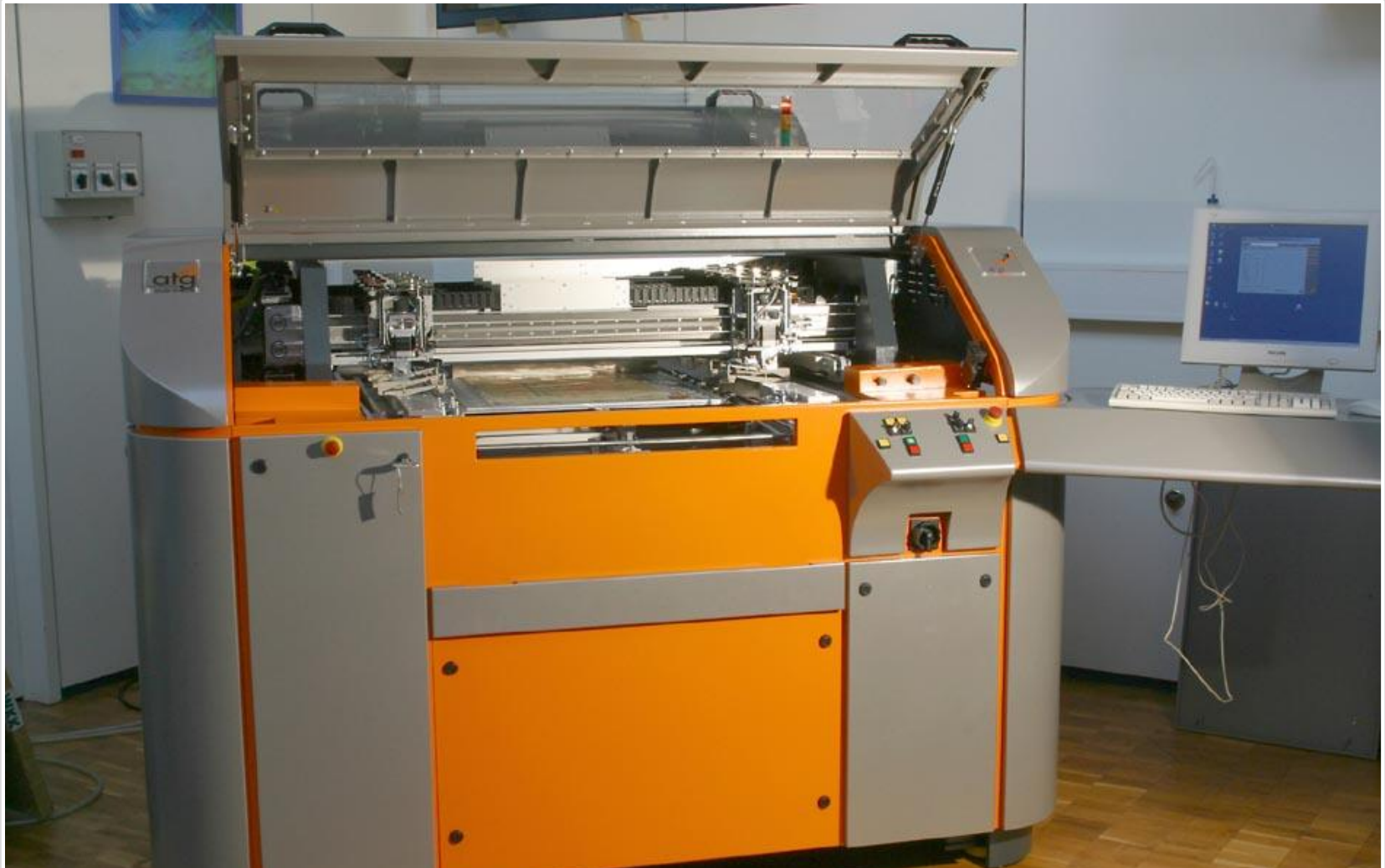
Tester für unbestückte Leiterplatten mit Zustapler
